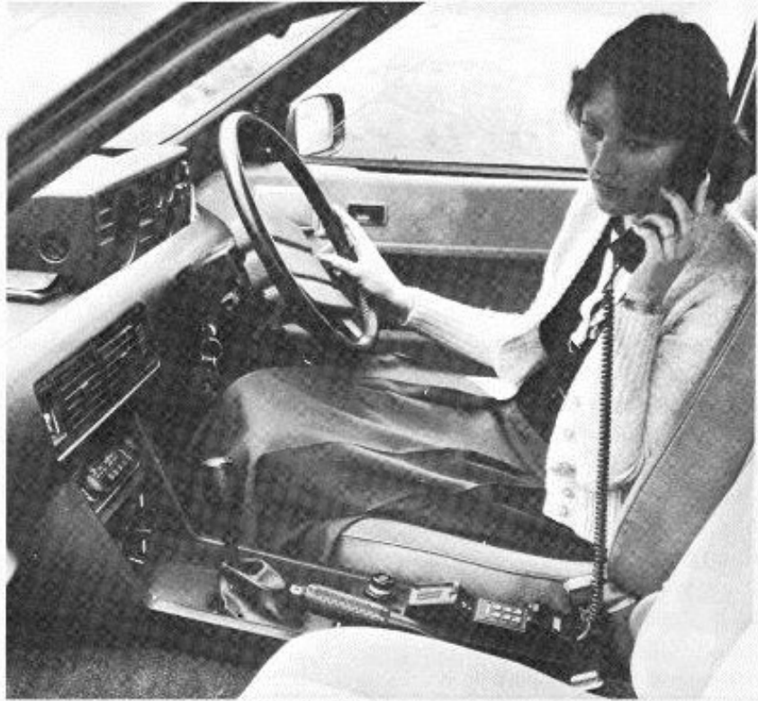
A 55-channel Marconi SV 1320A radiophone
